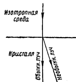
Рис. 13 Отклонение необыкновенного луча при нормальном падении света на преломляющую грань кристалла.
